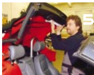
5 Einziehen: Schrauben der Kunststoffblende lösen, Innenverdeck unter die Blende ziehen und befestigen
