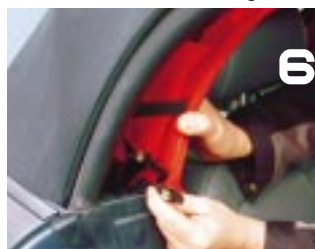
6 Verkleiden: Die Ecken des Verdecks lassen sich dank Druckknöpfen an den Gummibändern leicht befestigen
