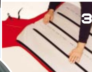
3 Kontrolle: Das Innenverdeck ist vormontiert, Leisten und Befestigungsbänder vernäht
