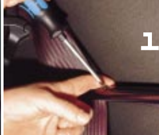
1 Abschrauben: Jeweils zwei Schrauben an den Kunststoffleisten des Verdeckgestänges entfernen
